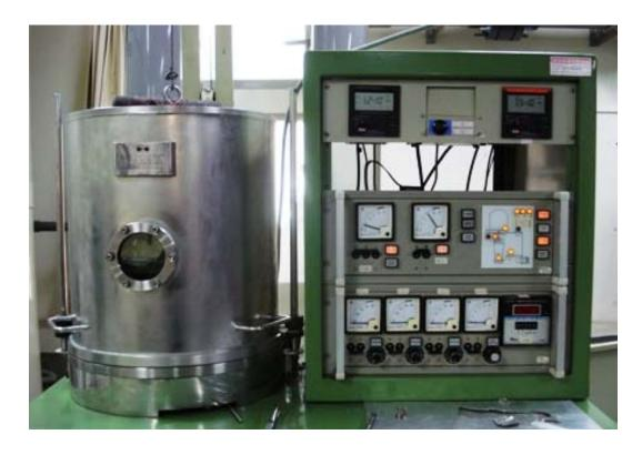
真空蒸鍍與化學電鍍不同,它是一種以物理方法取得表面膜層的方法。此種方法的特點 是在真空條件下加熱蒸發源,將待蒸發的熱穩性化合物加熱至高溫,使之揮發成蒸氣霧而噴 敷在試樣表面,因而達到蒸鍍的目的。
