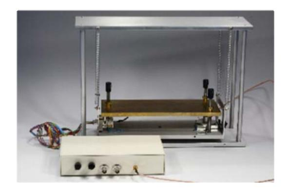
介紹STM的原理之前,我們必需先知道什麼是「穿隧效應」(tunneling effect)。電子穿隧現象乃量子物理的重要內涵之一;在古典力學中,一個處於位能較低的粒子根本不可能躍過能量障礙到達另一邊,除非粒子的動能超過能障。但以量子物理的觀點來看,卻有此可能性。所謂的「穿隧效應」就是指粒子可穿過比本身總能高的能量障礙。當然,穿隧的機率和距離有關;距離愈近,穿隧的機率愈大。當兩個電極相距在幾個原子大小的範圍時,電子已能從一極穿隧到另一極。穿隧的機率是和兩極的間距成指數反比的關係。對一般金屬而言(功函數約4-5eV),1埃的間距差可導致穿隧電流10倍的增減。所以,藉偵測穿隧電流,可很容易地得知兩電極間距的變化達0.1埃的程度。至於在水平方向的解析度,則受限於針尖的大小,一般約為1~2埃。掃描穿隧顯微術即利用這種電子穿隧特性而發展出來的。如果上述電極中的一極為金屬探針(一般為鎢針),另一極為導電樣品,當它們距離很近(小於1nm),並在探針加上微小偏壓,則探針所在位置便有穿遂電流產生。
